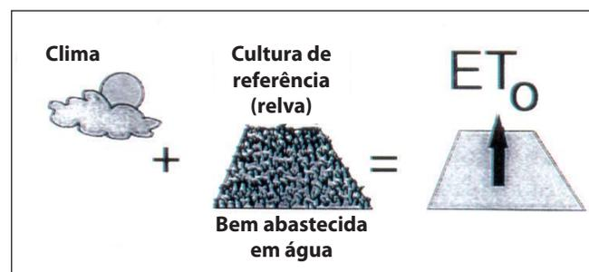
**Representação esquemática dos factores envolvidos na estimativa da evapotranspiração de referência (ET<sub>0</sub>).**
