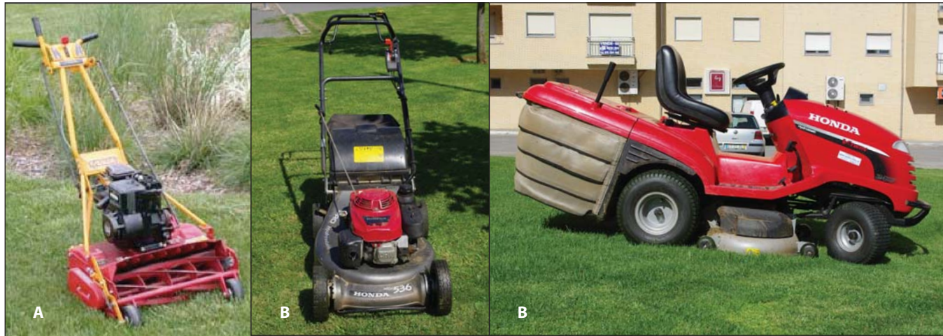
Equipamentos de corte automotrizes: A – lâminas helicoidais (Adaptado de Voight e St.John, 2008.) ; B – lâminas rotativas.
