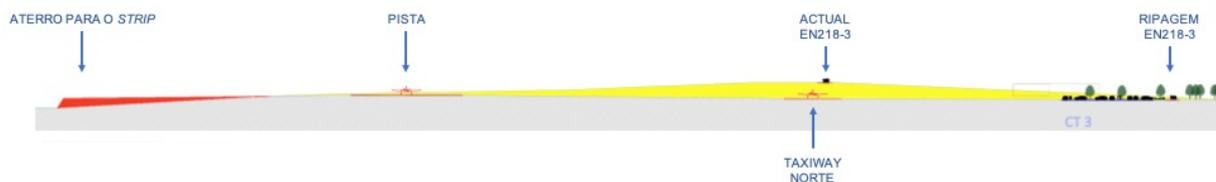
Figura 21 - Esquema ilustrativo dos movimentos de terras previstos para a Fase 5
