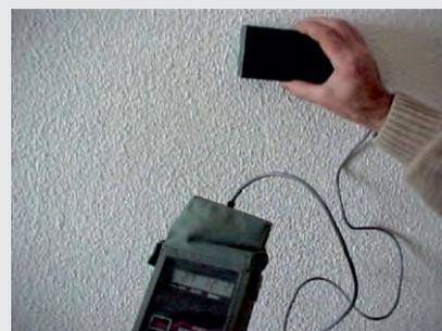
Figura 9 – Inspeção com pacómetro e detetor de corrosão
