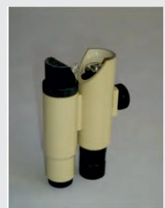
Figura 2 – Fissurómetro e medidor ótico de fissuras
