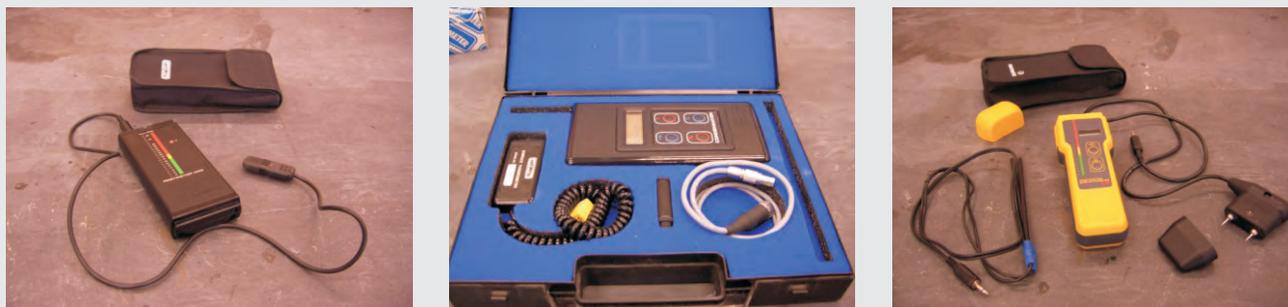
Figura 7 – Termohigrómetros digitais
