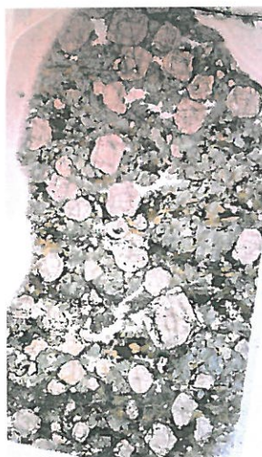
Foto 3 – Lâmina delgada de granulito máfico para estudo ao microscópico petrográfico. Destacam-se as granadas (mineral de cor vermelha) no fundo verde das piroxenas (foto de Diana Miranda. 2015).
